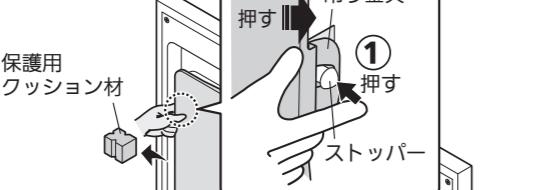
3) 整流板をそのままゆっくり開き、整流板の奥側を本体側に押し付けるようにしてフード引掛け部から整流板引掛け部をはずします（⑥）。
