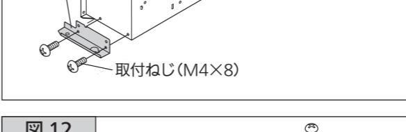
14) 排気口の引掛金具の取付ねじ（M4×8）2本をはずし、反対側に付け替えます。（図15）
