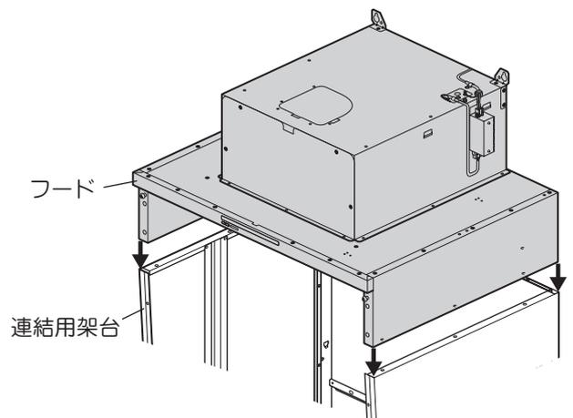
2) フード下側から、フードの側面および背面をトラスねじ (M4×10) 各3本〔フード付属品〕でそれぞれ固定します。
