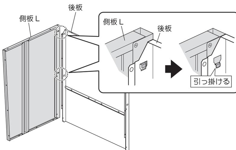
2) トラスねじ(M4×10)3本〔フード付属品〕で、側板Lを後板に固定します。
