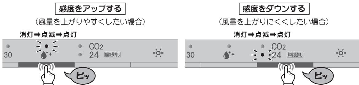
※[洗浄ランプ] [常時換気ランプ] の両方が消灯している状態が“標準”レベルです。
