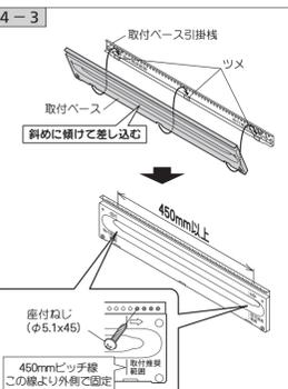
※ 取付推奨範囲外での取り付けや壁面の強度などの影響でレンジフードが前ダレする場合は、市販のねじで増し打ちしてください。
