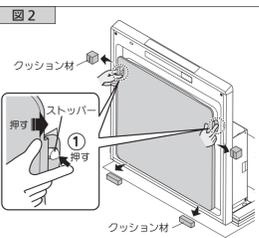
2) 整流板を両手で支え、左右にあるストッパーを押して引掛部から整流板引掛部をはずします(①)。
