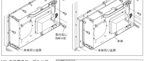
13) 本体側のケーブルとフード側のケーブルを接続します。接続後、フード側のケーブルをクランプに図のように取り付けます。(図15)
