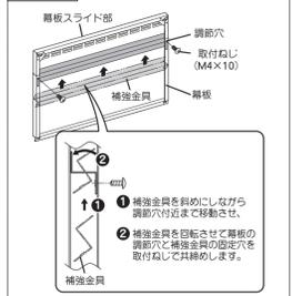
1) 補強金具を幕板裏面に差し入れ、幕板の高さ調整穴付近まで移動させます。
