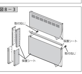
※ 幕板の保護シートをはがす際は、取付ねじをはずし、幕板を上下に分割してはがしてください。
