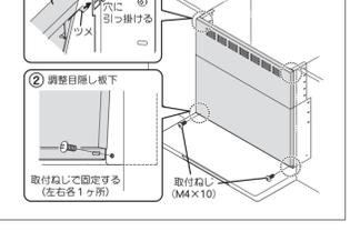
2) 幕板と調整目隠し板下のねじ穴を合わせ、付属品の取付ねじ(M4×10)2本で固定します。
