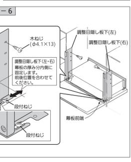
1) フード左右の取付ねじに調整目隠し板下の下部にある切り欠きを差し込み、前後にスライドさせて位置を合わせます。
