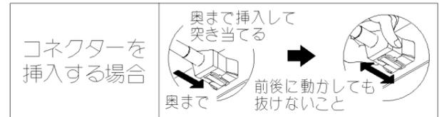
※コネクタを挿入する際は、ツメの向きを合わせて確実にロックしてください。コネクタを確実に接続しないと作動不良や故障の原因になります。
