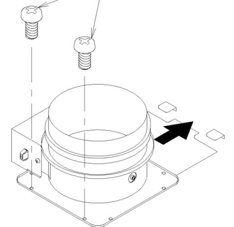
(4) 電動シャッター信号線と排気口を接続します。
