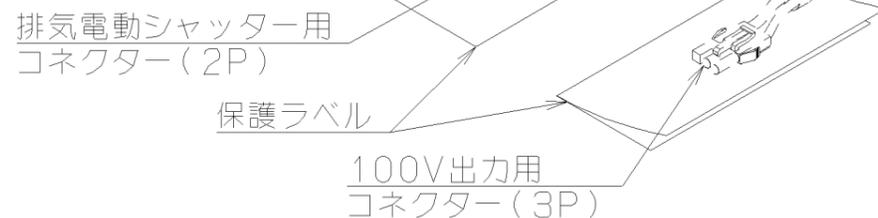
(2) 運動線と電動シャッター信号線を接続します。
